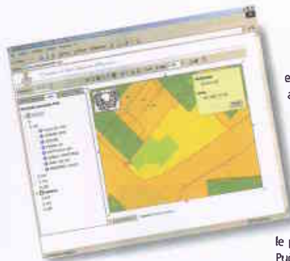
Figura 3 - Zoom su un dettaglio di particella, con visualizzazione dei dati ad essa associati e calcolo di perimetro e area della stessa
